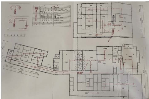
自動火災報知器等の設備系統図
